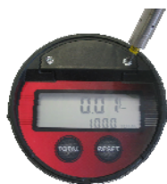
Bild 1: Lösen des Batterie-deckels
