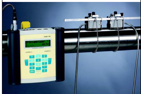
Messung mit Sensoren, montiert mit Anklemschuhen, und mit Messumformer, befestigt mit der QuickFix-Rohrbefestigung
