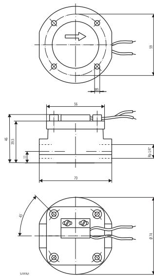
Ferntotalisator zu VZO 4 OEM - RE 0.005 / Remote totalizer for VZO 4 OEM - RE 0.005 / Totalisateur à distance pour VZO 4 OEM - RE 0.005
