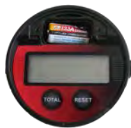
Bild 2: Herausnehmen der Batterie
