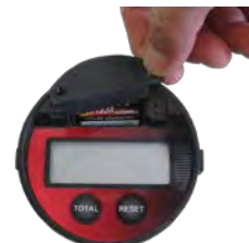
Illustration 4: Revisser le couvercle de la pile
