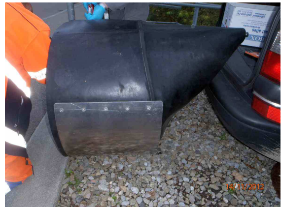
Die Rückstausicherung vor dem Einbau
